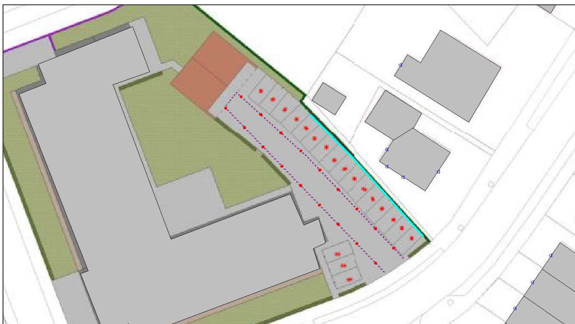
Afbeelding 4 Situering scherm (schermhoogte 2 meter boven plaatselijk maaiveld)
