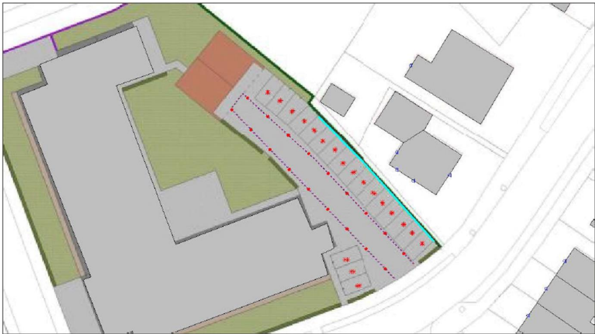
Afbeelding 5 Situering scherm – schermhoogte 2 meter boven maaiveld (Bron: Kragten BV)
