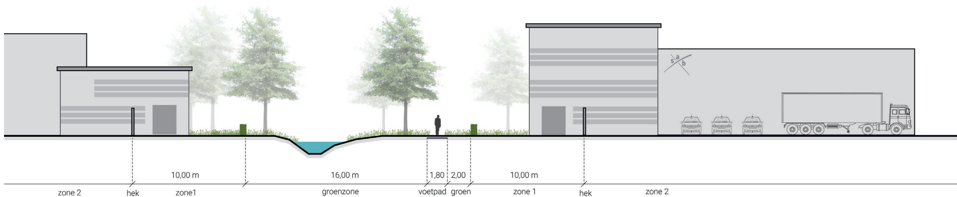
Principeprofiel 3: centrale groenzone met watergang (alleen in scenario 1)
