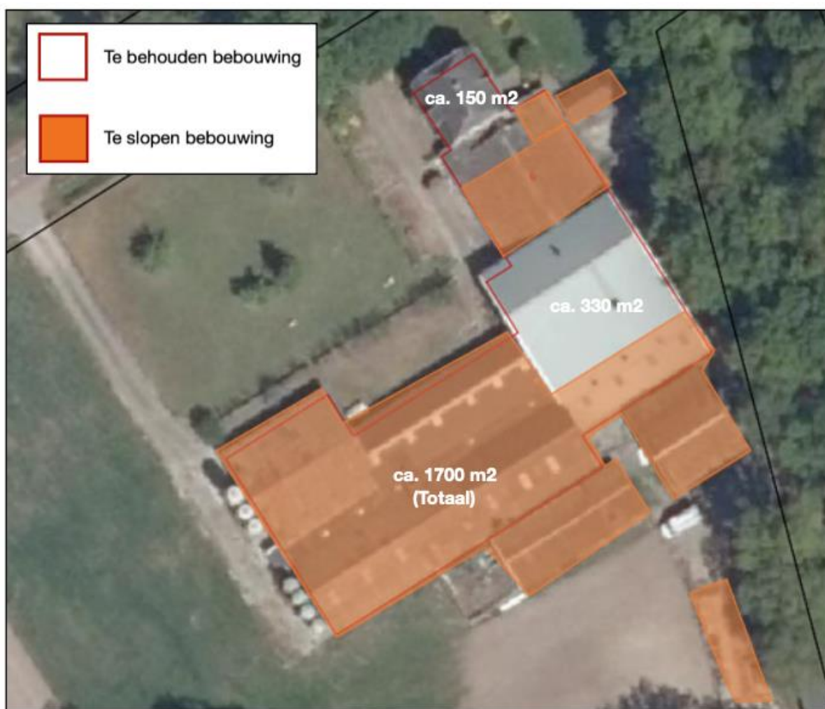
Afbeelding 3.1 Te behouden en te slopen bebouwing (Bron: initiatiefnemers)
